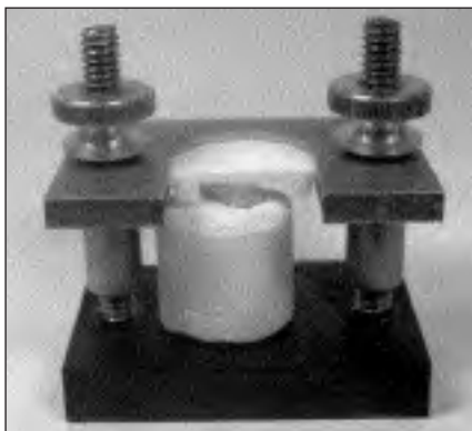
1. ábra: Az előkészített és beágyazott fogcsoportot rögzítő eszköz
